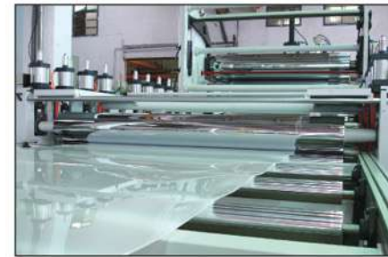
滾輪之升降控制系統採用油壓控制，控制成型厚度更穩定。 Roller ascending equips hydraulic control to have stable plat thickness.
