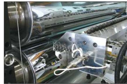
滾輪之升降控制系統採用油壓控制，控制成型厚度更穩定。 Roller ascending equips hydraulic control to have stable plat thickness.
